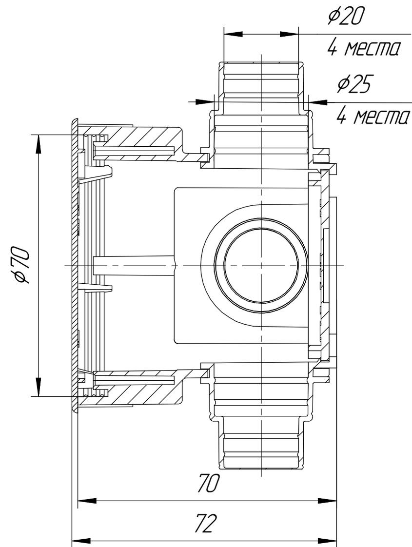
Коробка распределительная (для заливки бетоном) 80-0530 для о/п безгалогенная (HF)  $\phi 70 \times 72$
